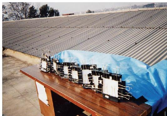
写真3  $\text{NO}_2$  濃度測定装置(Tribhuvan 大学屋上)
