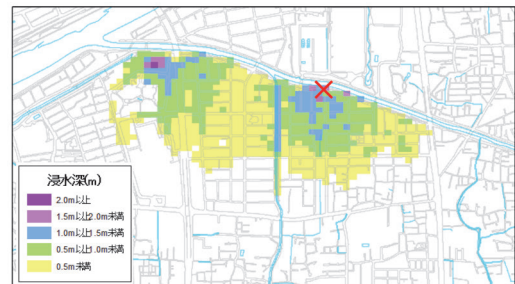
図 6 最大浸水深(上:case1 下:case2)
