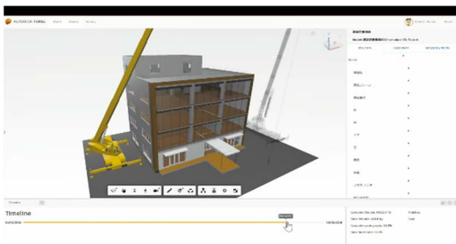
図 9 クレーンシミュレーション画面
