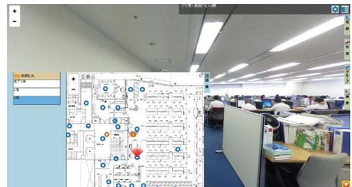
図 7 パノラマ写真とその撮影位置を示したフロア図 (青丸:撮影位置、赤扇:撮影方向)
