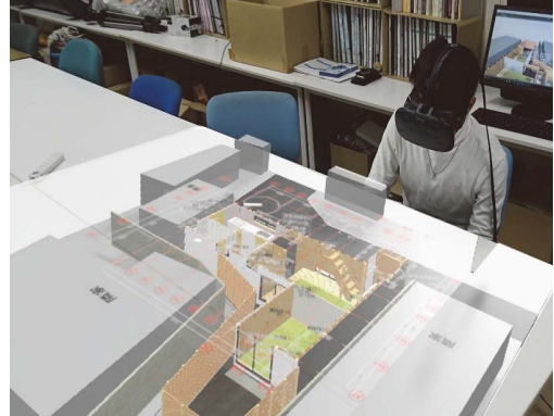
図 7 VR 図書（平面詳細ビュー）のイメージ ゲームエンジンを用いて実証実験の環境を構築
