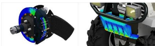
図 6 Autodesk Inventor Nastran シミュレーション結果 (左:振動解析 、右:熱解析)
