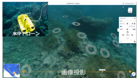
図 5 水中ドローンの映像から生成した点群データ
